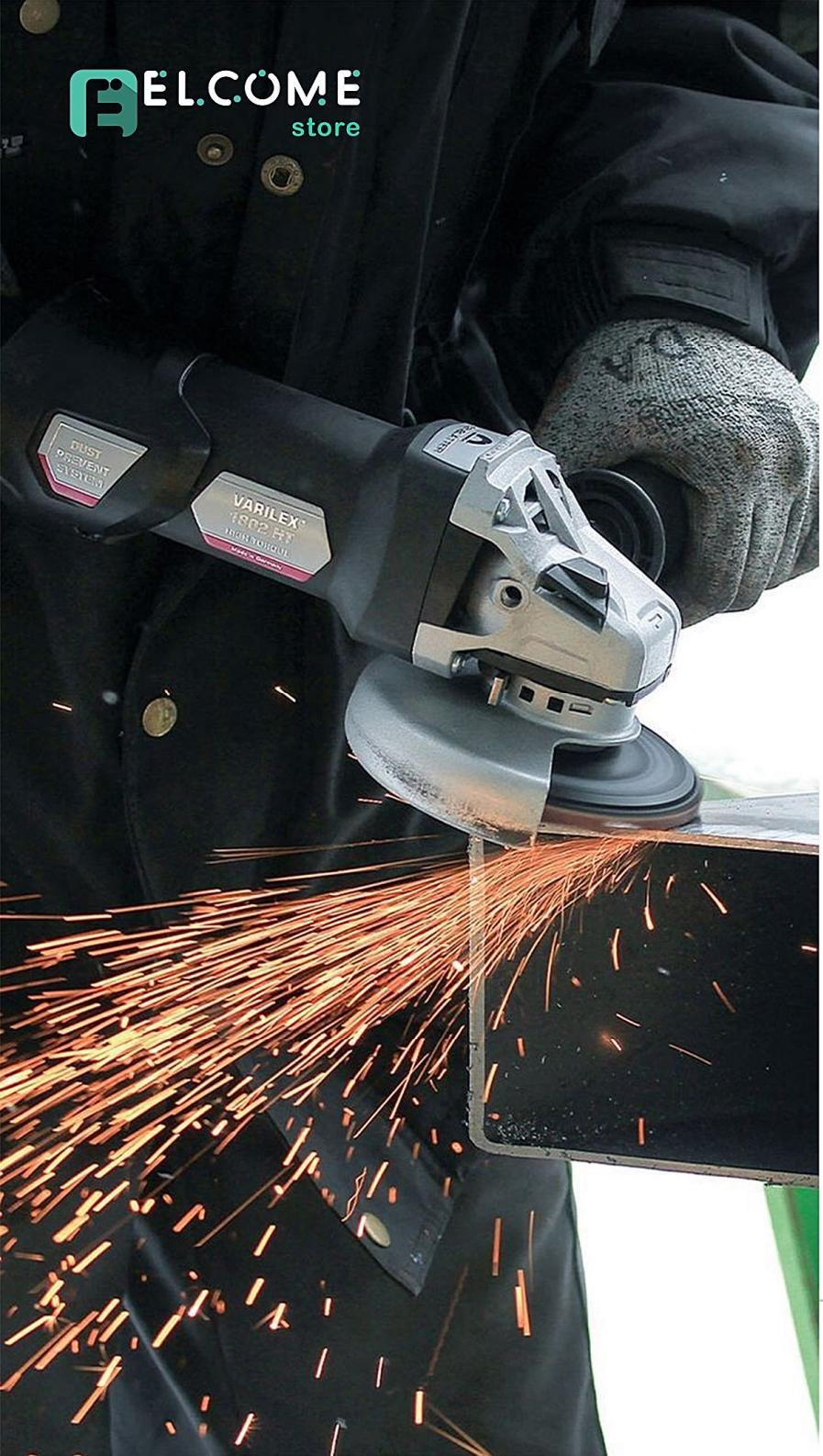
صفحه برش یا دیسک برش (Cutting Wheel یا Cutting Disc) ابزاری است که برای برش انواع مواد مختلف مانند فلزات، سنگ‌ها، بتون، چوب و پلاستیک استفاده می‌شود. این صفحات به دستگاه‌های مختلفی مانند فرز، اره دیسکی و دستگاه‌های برش صنعتی متصل می‌شوند و با سرعت بالا چرخیده و فرآیند برش را انجام می‌دهند.
