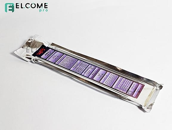
الکترود چدن نیکلی ۱۰۹۴Ni E Ni-CI AMA برای جوشکاری چدن و اتصال آن به فولاد، مس و آلیاژهای نیکل مناسب است. این الکترود قوس پایدار و جوش تمیزی دارد، ترک نمی خورد و عاری از مک و تخلخل است. همچنین، عملیات برداشت برآده روی جوش ممکن بوده و چکش کاری گرده جوش تنفس جوشکاری را کاهش می دهد.
