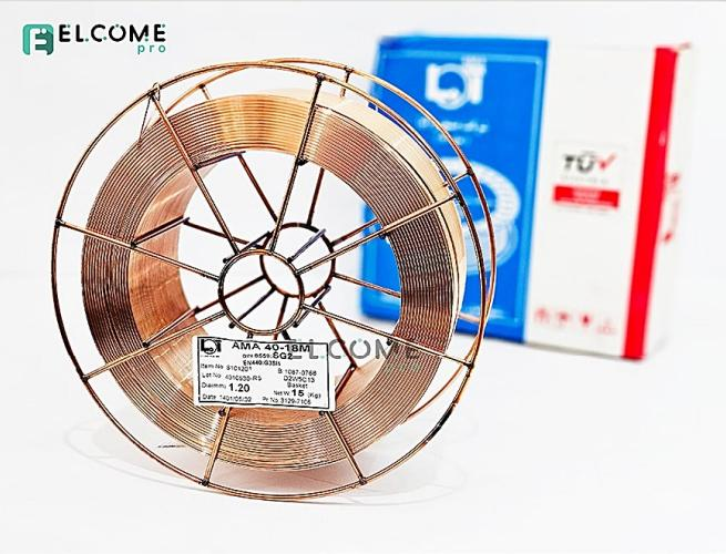
برند آما با تجربه سالهای فراوان تولید این نوع سیم جوش با اختلاف بهترین کیفیت را در بین برندهای ایرانی دارد. این سیم جوش برای جوشکاری میگ/مگ فولادهای عمومی ساختمانی و فولادهای لوله با استفاده از گاز CO2 و دیگر مخلوط گازها نظیر گاز آرگون با ۵ تا ۲۵ درصد CO2 بکار می‌رود.
